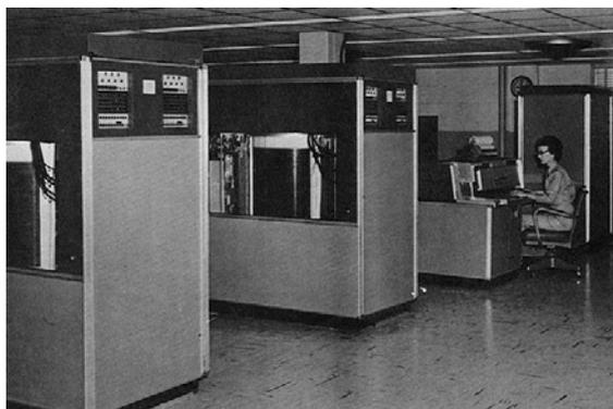
*L'IBM 305 RAMAC : Premier ordinateur à utiliser un disque dur. Sa capacité était d'environ 5 Mo et pesait près d'une tonne.*
